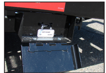
2.) Air Ramp Control Box
